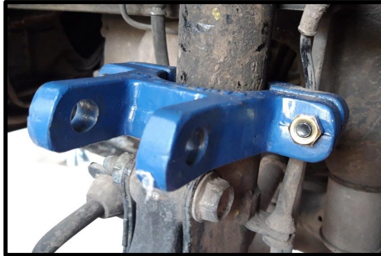
Figura 2.28 Posicionamiento soporte A
