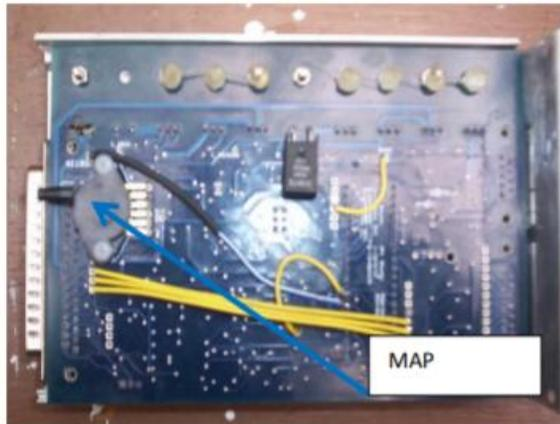
*Figura 41: Instalación del sensor MAP*
