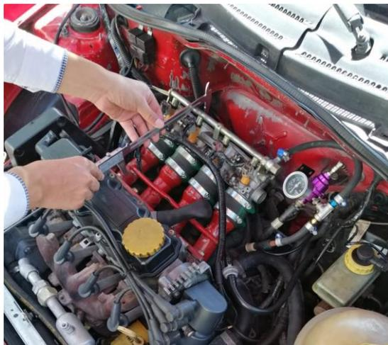
*Figura 36: Toma de medidas del colector de admisión convencional*
