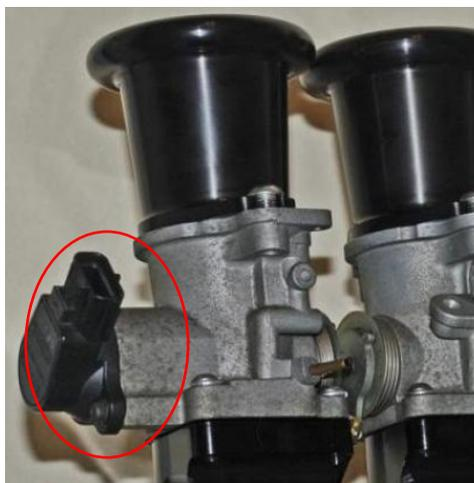
Figura 10: Sensor TPS implementado en sistema ITBs
