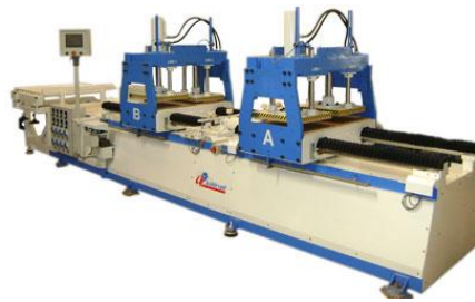
Figura 7. Sistema de tracción mediante cilindros reciprocantes hidráulicos [19].
