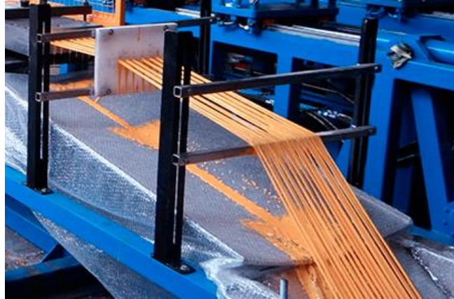
Figura 5. Preformado de las fibras saturadas que salen del tanque [15].
