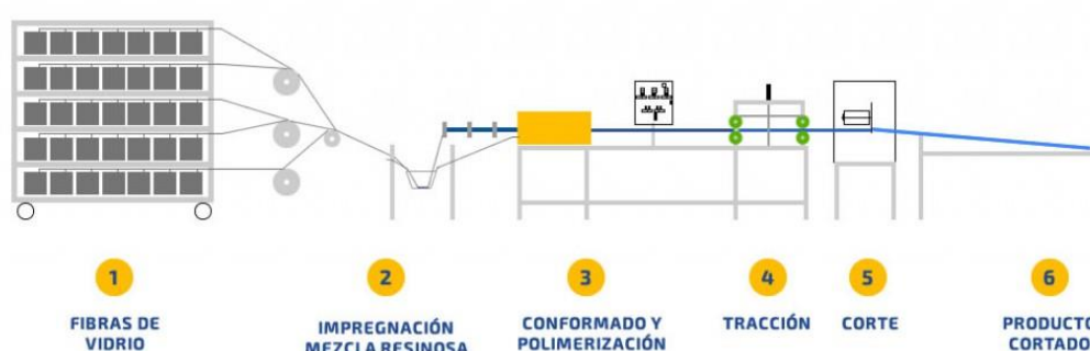
Figura 2. Esquema que muestra el proceso de pultrusión. [12]
