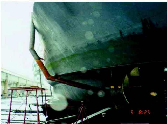
Bild 5: Konstruktion zur Kalibrierung an der Mon Desir
