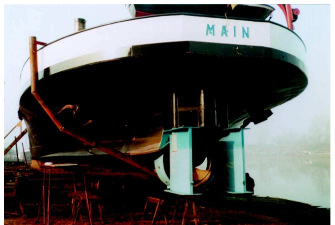
Bild 6: Konstruktion zur Kalibrierung an der MS Main
