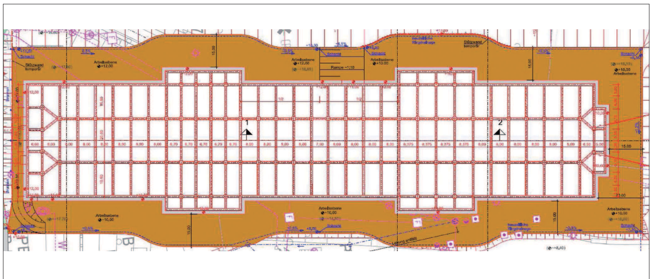
Bild 9: Draufsicht auf die Baugrube der neuen Schleuse Lüneburg mit möglichem Steifenlayout (Planungsstand 03/2015) Figure 9: Plan view of the building pit of Lüneburg lock with a potential strut layout (as at 03/2015)
