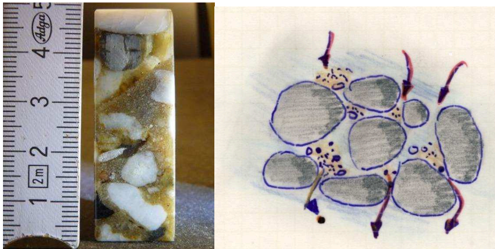
Bild 2: Links: Verguß eines weitgestuften Sedimentbodens. Skelett aus Kies, eingelagerter Sand. Rechts: Prinzipskizze zur Migration des feinen Anteils durch Porenpfade des Skeletts
