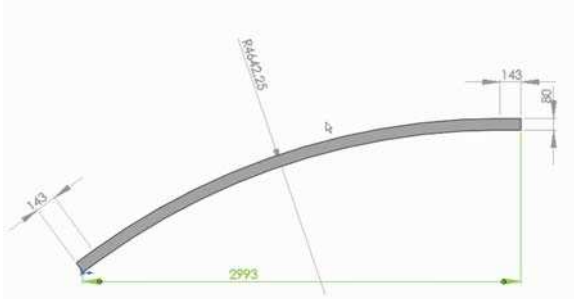
Bild 1: Bauraumgerechte Gestaltung der Torflügelform
