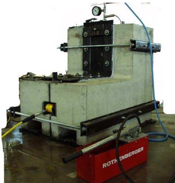
Bild 2: Versuchsmodell - stahlseilbewehrtes Klemmfugenband
