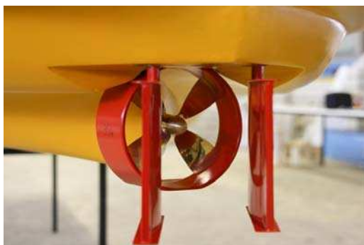
Bild 1: Hinterschiff des GMS-Teilmodells (DST-Modell M1850) mit Propeller in Kortdüse und Zwillingruder (links) und freischlagendem Propeller mit Zentralruder (rechts)
