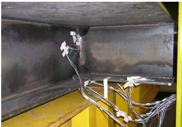
Bild 3: Bauteilversuch Kerbdetail 1, Lastbild für die Bauteilversuche
