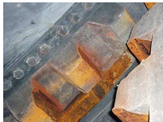
Bild 1: Plastische Verformungen an Zahnschiene und Zahnkränzen der Versenkwalze der Mainstaustufe Viereth (Braun, 2009; Braun, 2012)
