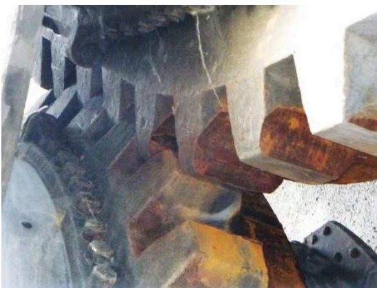
Bild 1: Plastische Verformungen an Zahnschiene und Zahnkränzen der Versenkwalze der Mainstaustufe Viereth (Braun, 2009; Braun, 2012)
