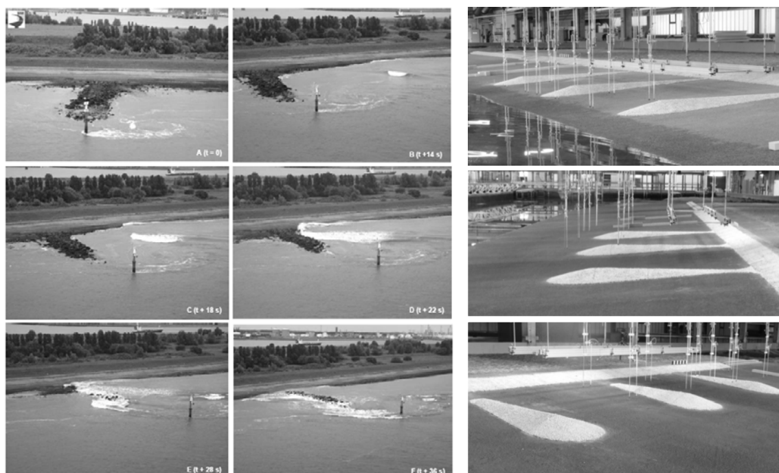
Abb. 8: Ablauf der dynamischen Belastung einer Buhne durch die schiffserzeugte Primärwelle (links) und untersuchte Buhnenvarianten im Modellmaßstab 1:40 bei der BAW (Fotos: BAW)
