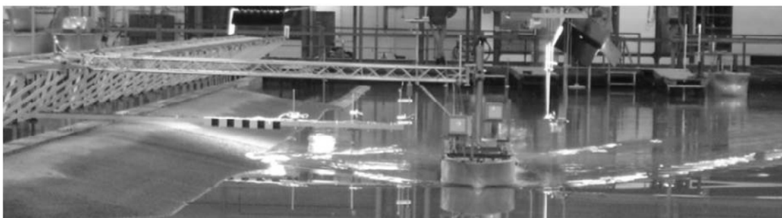
Abb. 4: Modellversuch Maßstab 1:40 zur Ermittlung der schiffserzeugten Belastung einer Böschung bei Passage eines PanMax-Containerschiffs (Foto: BAW, 2009)
