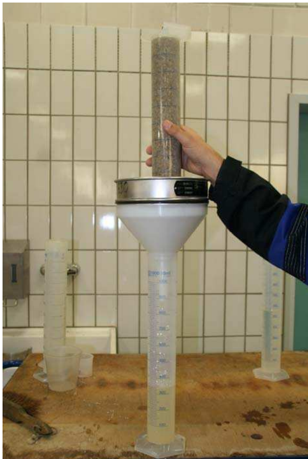
Bild 7: Versuchsanordnung zur Ermittlung des nutzbaren Porenvolumens in Schüttgütern über die Messung des frei auslaufenden Wassers. Hier ist die Entleerung einer Filterkiesschüttung in einem 1 Liter-Gefäß abgebildet. Foto: Lothar Schoka, Bau-ABC Rostrup.
