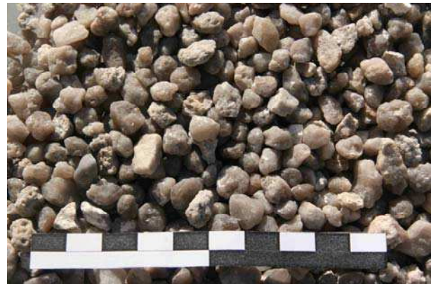
Bild 4: Haufwerk eines locker gelagerten Filterkieses 5,6 bis 8\text{mm} . Foto: Fa. Ochs, Nürnberg
