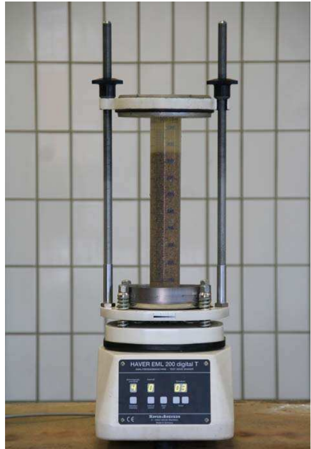
Bild 9: Versuchsanordnung zur Ermittlung des Setzungsverhaltens in Schüttgütern über die Messung des Setzungsmaßes [mm]. Foto: Lothar Schoka, Bau-ABC Rostrup.
