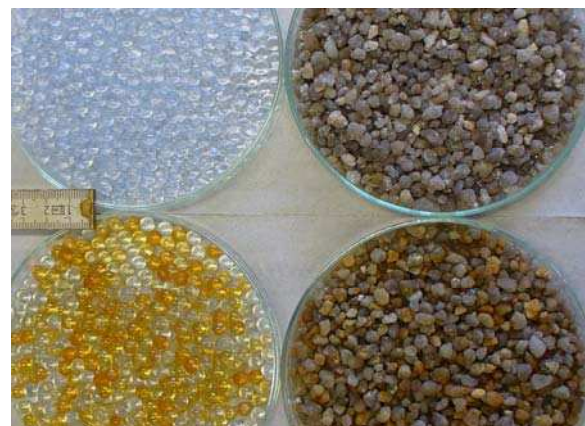
Bild 1: Anlagerung von Eisenhydroxiden an Glaskugeln und Filterkies. Foto: Christian Hein, Universität Bayreuth.
