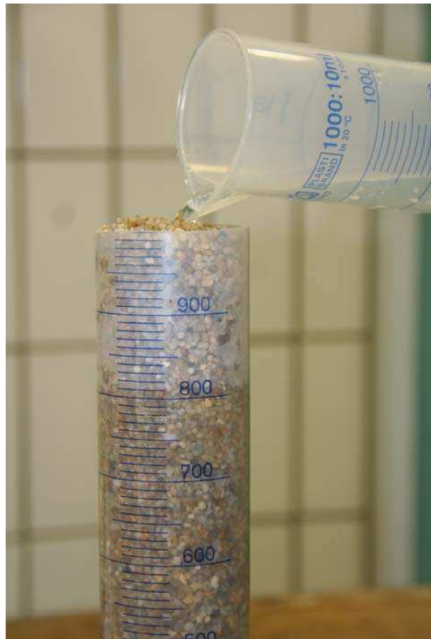
Bild 6: Versuchsanordnung zur Ermittlung des Gesamtporenvolumens in Schüttgütern. Hier ist die Befüllung einer Filterkiesschüttung in einem 1 Liter-Gefäß abgebildet. Foto: Lothar Schoka, Bau-ABC Rostrup.
