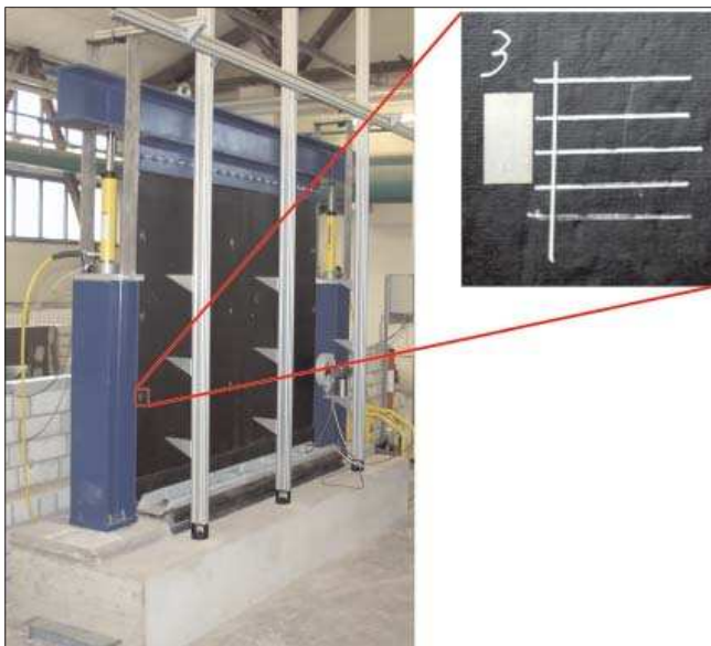
Bild 13: Großer Versuchstand Langzeitversuch mit Messfeld
