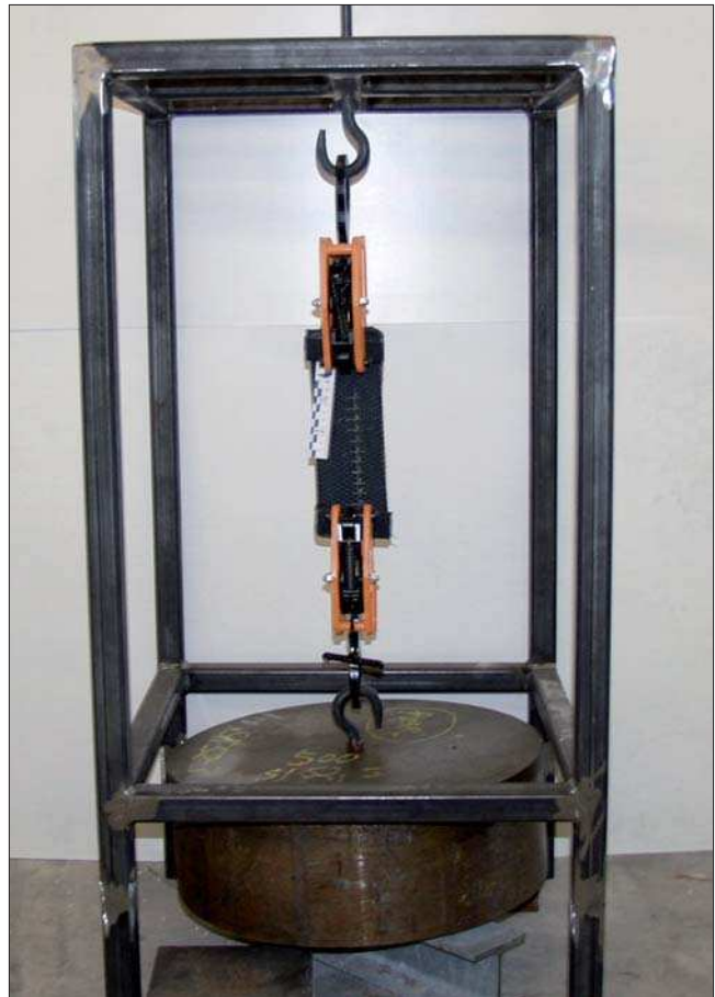
Bild 15: Kleiner Versuchsstand Langzeitversuch mit Probe und Messmarkierungen
