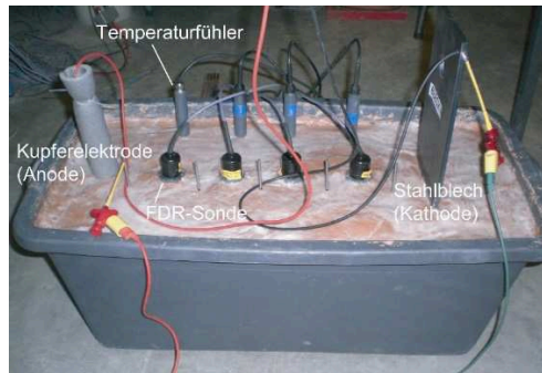
Abbildung 3: Versuchsaufbau für den Herausziehversuch mit Messung des Feuchte- und Temperaturtransports.
