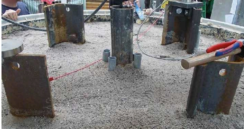
Abbildung 7: Versuchsanordnung: In der Mitte: Anode aus Stahlrohr d = 11,4 cm; außen 4 Kathoden in Form von halbierten Spundwandprofilen Arcelor GU 16-400.
