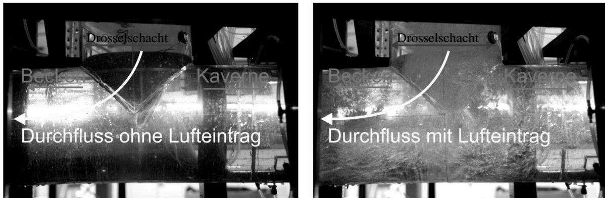
**Abbildung 4:** Ausfluss aus einem Wasserschloss ohne Lufteintrag (links), Lufteintrag in einen Druckstollen (rechts)
