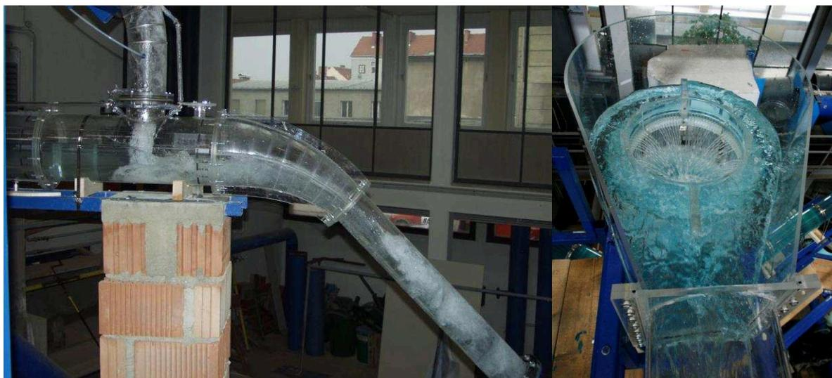
**Abbildung 5:** Entleeren eines Steigschachtes in eine durchflossene Unterkammer (links), Entleervorgang aus einer Oberkammer (rechts)
