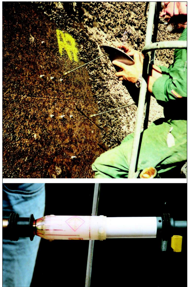
Bild 2.2: Druckkissen vor Einbau in die Kammerwand und Triaxialzelle mit Dehnungsmessstreifen
