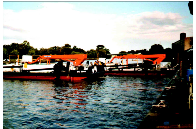
Bild 5.20: Brückenuntersuchungsschiffe BU 3960 und BU 3961 während der Erprobung, September 2001
