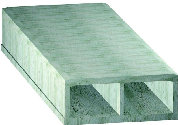
Bild 2.13: Mittelteil des Stever-Durchlasses
