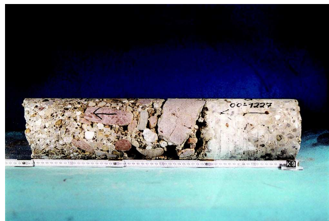
Bild 2.6: Schleuse Obernau - Bohrkern aus der Mainseitigen Kammerwand
