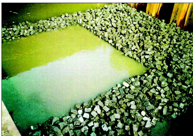
Bild 3.19: Schüttung und Verdichtung von Würfelton in einer Versuchsgrube
