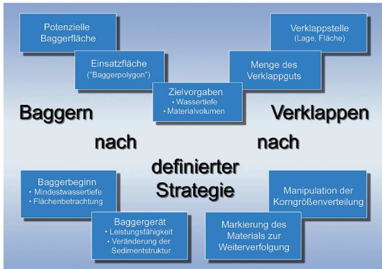
Bild 5: Komponenten einer modellgestützten Bagger- und Verklappstrategie
