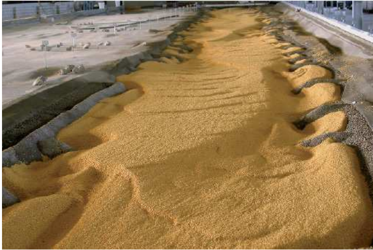
Bild 1: Physikalisches Modell der Oder bei Hohenwutzen (Standort: BAW, Karlsruhe)
