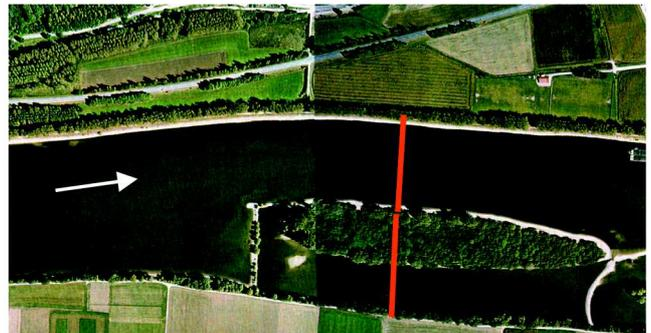
**Messquerschnitt km 2280.3; 1848 m<sup>3</sup>/s**
