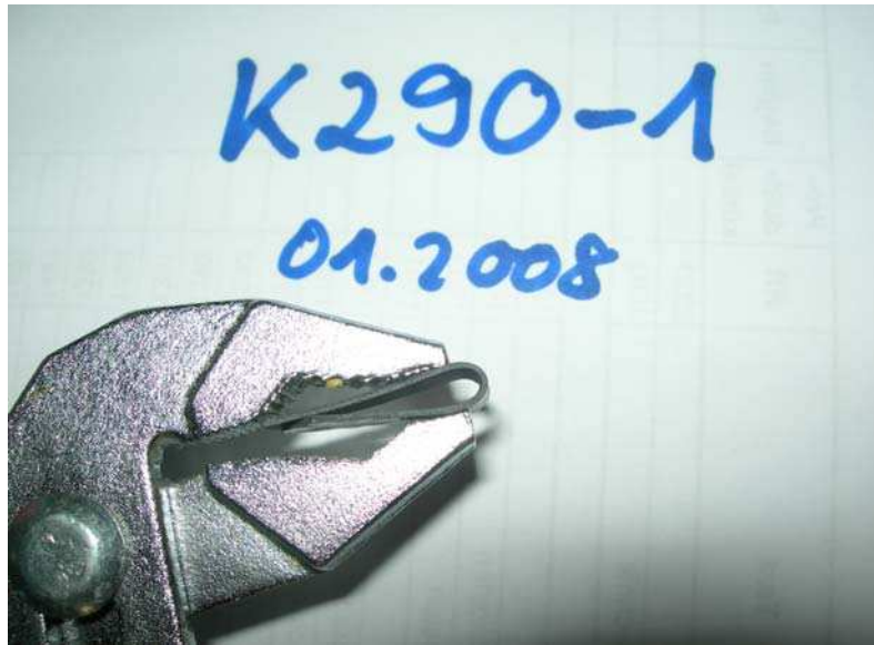
Abbildung 4: Stark verbogene Materialprobe (EP mit 5 Gew.-% Verdünnung)
