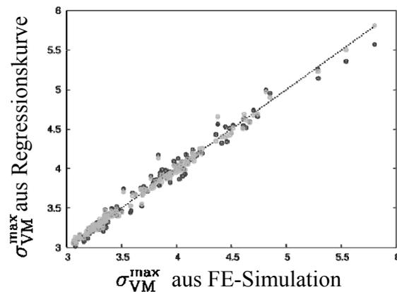
**Abbildung 5:** Approximation der maximalen Von-Mises Spannung in Feldmitte
