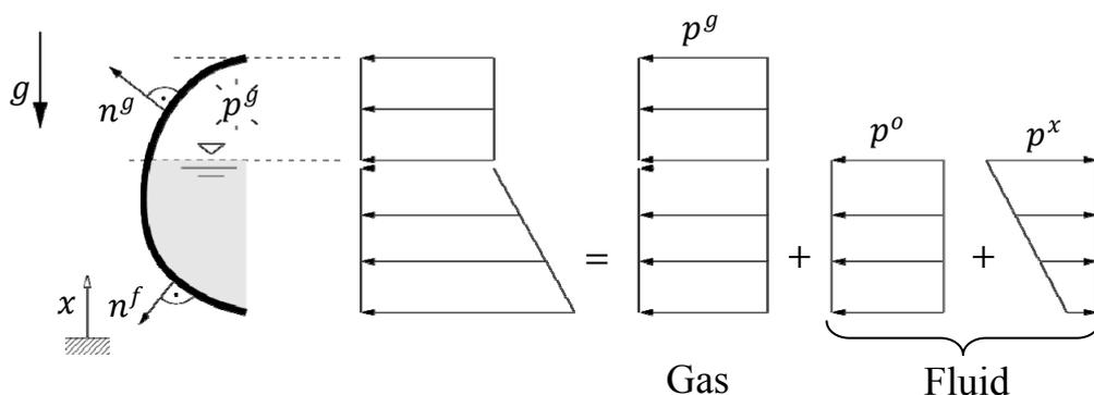
**Abbildung 3:** Hydrostatischer Druck in einer teilweise gefüllten Kammer
