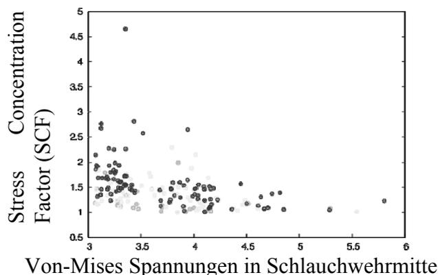
**Abbildung 6:** Stress Concentration Factor für Schlauchwehre mit Wasserfüllung
