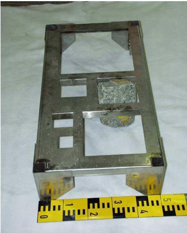
Bild 2: Größenermittlung D über ein Quadratlochsieb
