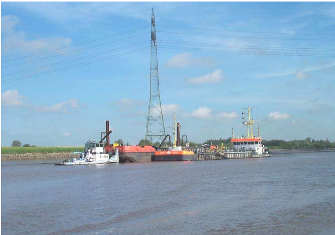
Bild 2: Hopperbagger mit längsseitiger Schute
