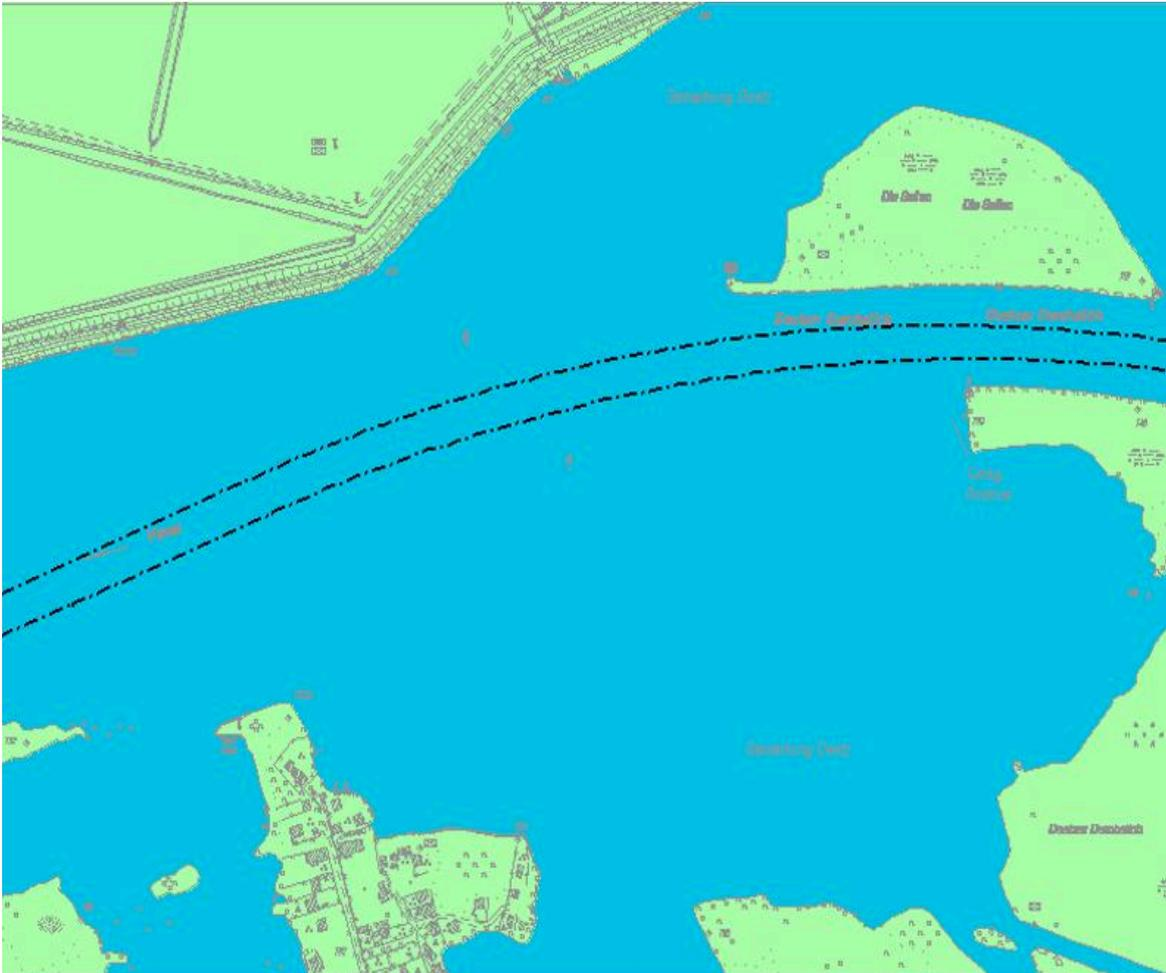
**Bild 24:** Erster Trassierungsschritt: Konstruktion der Kursachsen
