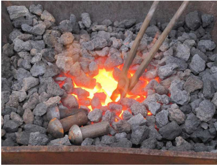
Bild 6: Erwärmung der Niete vor dem Setzen
