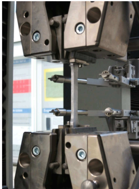
Bild 4: Durchführung eines Zugversuches mit Feindehnungsaufnahme an einer Stahlprobe im Prüflabor der BAW Karlsruhe
