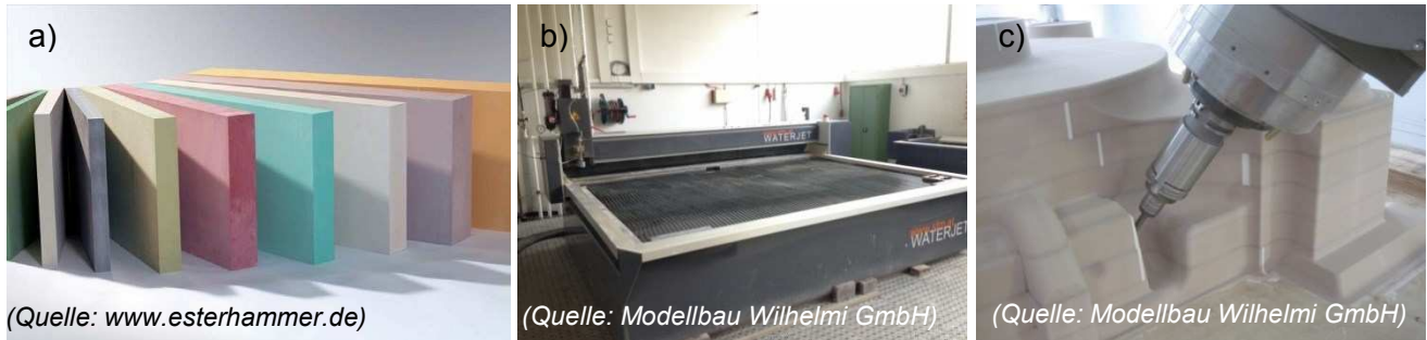
Bild 3 a) PU-Blockmaterial in verschiedenen Härtegraden; b) Wasserstrahlschneidemaschine; c) Fräskopf mit bearbeitetem PU-Blockmaterial einer 3D-CNC-Fräse;
