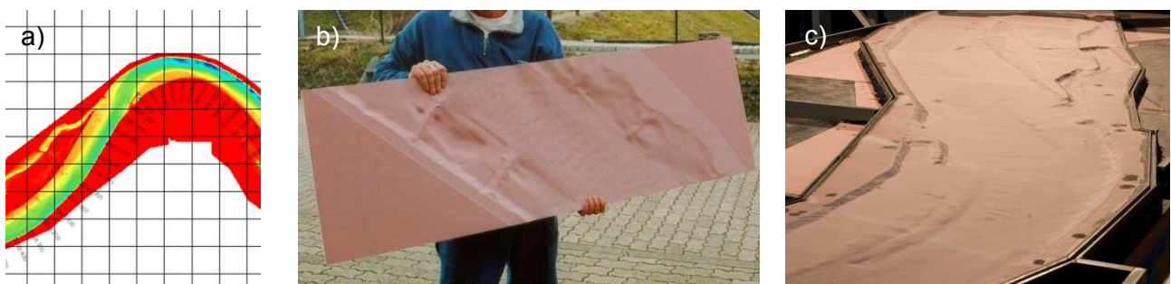
Bild 4: a) CAD-Daten des DGN; b) gefräste PU-Platte; c) zusammengesetztes Modell
