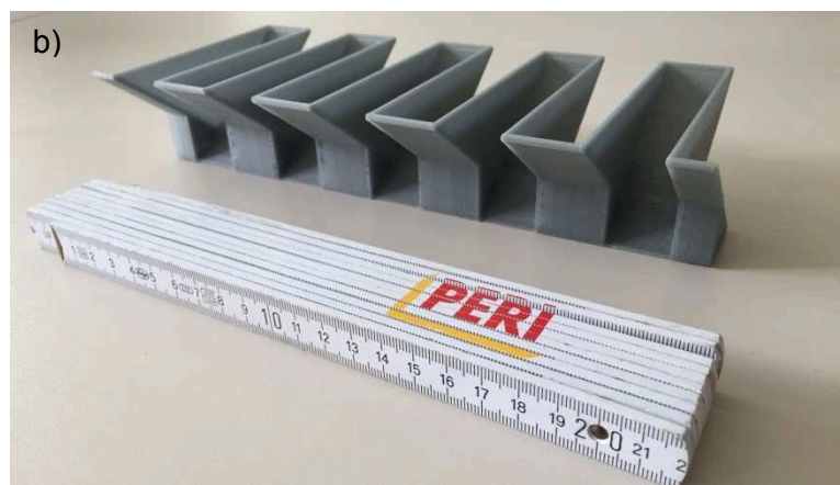
Bild 1: a) 3D-Drucker der Firma Stratasys; b) Tischmodell eines Piano-Key-Wehr
