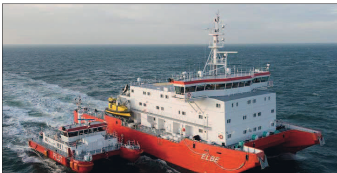
Bild 4.5: Lotsenschiff „ELBE“ mit dem 25 m Offshore Tender Figure 4.5: Pilot vessel „ELBE“ with the 25 m offshore tender
