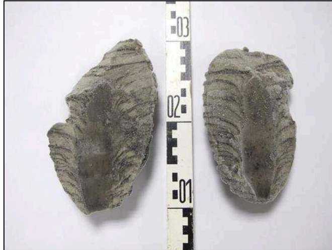
Abbildung 4: Teil einer aufgeschnittenen Gefrierkernprobe mit sichtbarer, durch Einschlagen der Lanze verursachte, Veränderung der Lagerungsverhältnisse.
