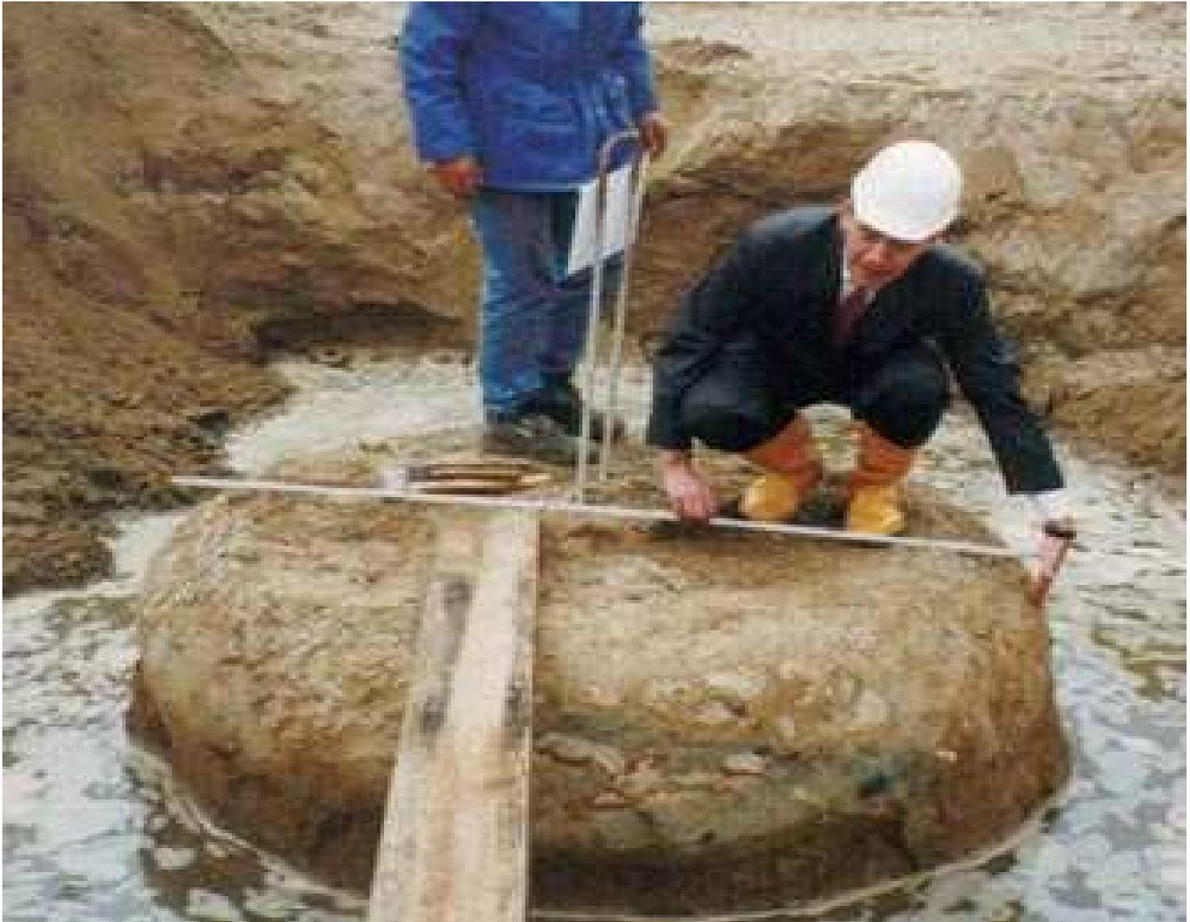
Bild 7: HDI-Probekörper
