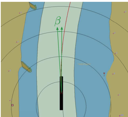
Abbildung 10: Automatische Bahnführung mit dem nötigen Driftwinkel \beta
