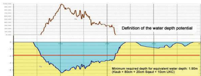
Abbildung 4: Definition eines Tiefenpotenzials im Flussprofil
