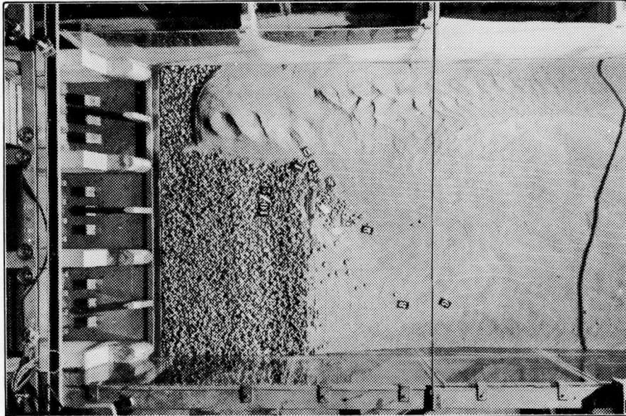
Abb.16 Kolkbildung und Zerstörungen an der Befestigungsstrecke beim Hochwasser-durchgang (oberes Wehrfeld geschlossen; Ausführungsvorschlag)
