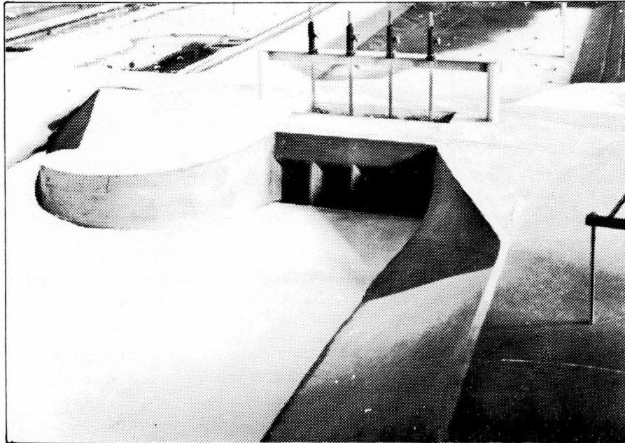
Abb.52 Nachbildung des Laufkraftwerkes im Gesamtmodell; Kraftwerkseinlauf
