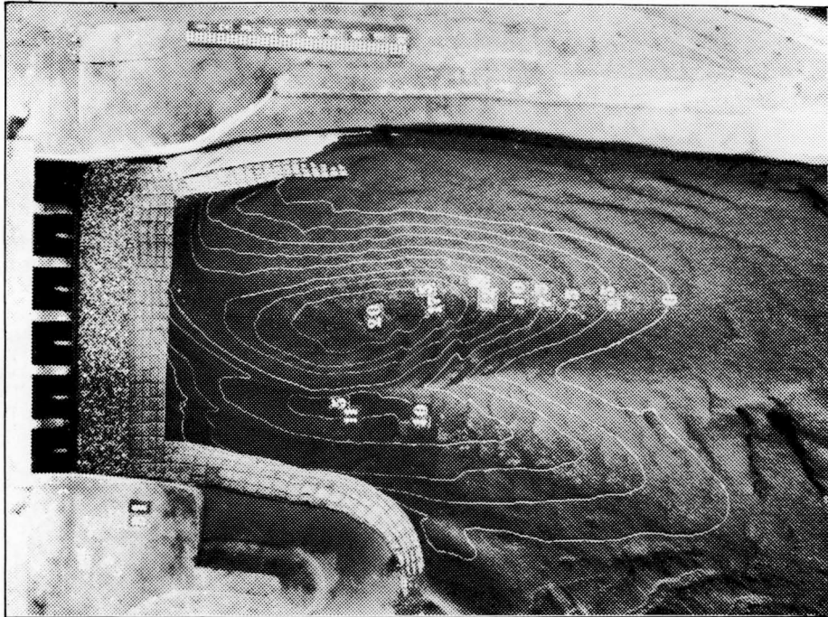
Abb.28 Kolsituation und stabiler Zustand der Sohlensicherung bei einwandfreier Ausbildung der flexiblen Übergangsstrecke nach Hochwasserdurchgang Q_2 und Betriebsfall S_1
