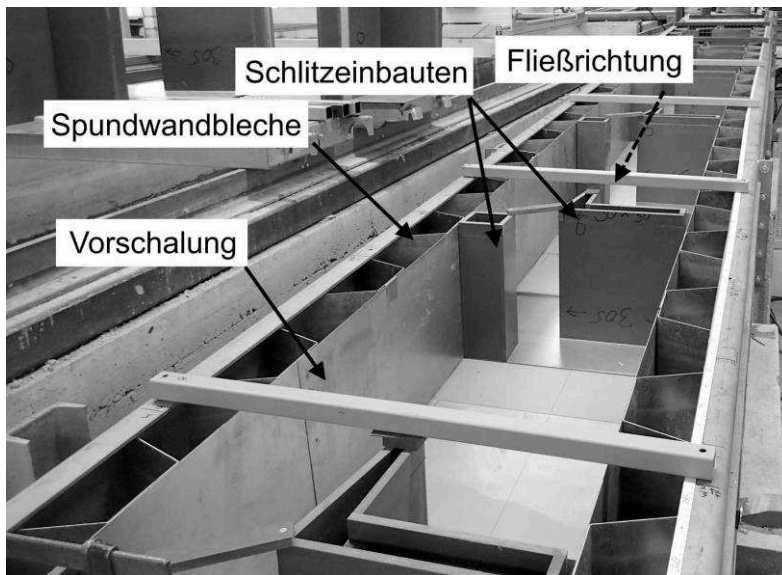
Abbildung 3: Modellaufbau im Wasserbaulabor
