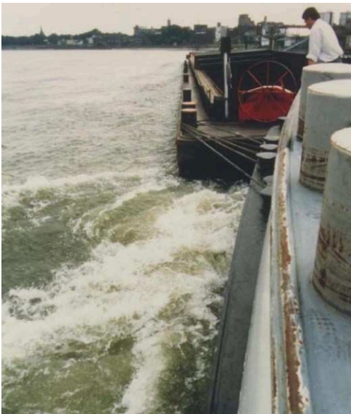
Bild 3: Wirbelbildung an der Koppelstelle
