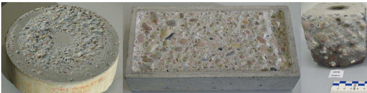
Bild 1: Prüfkörper der Prüfeinrichtung nach [ASTM, (2010)], der Plattenabrationstrommel und der Verschleißtrommel nach [Bania, A., 1989] und [Vogel, M., Müller, H.S., 2009]
