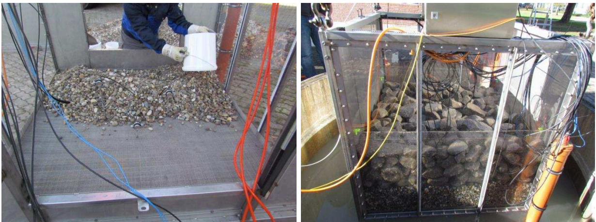
Bild 1: Einbau Kornfilter in den Versuchskasten (li.), Tauchvorgang mit Deckwerk (re.)
