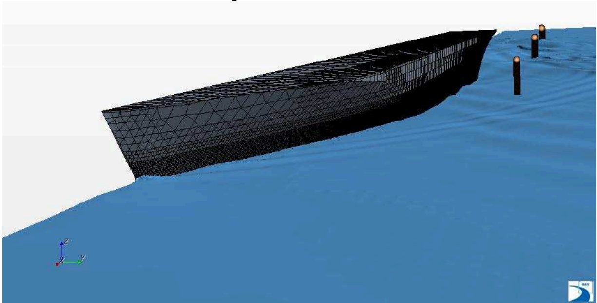
Bild 1: Oberflächendeformation bei wandnaher Fahrt in einem Kanal mit Böschung, symbolisch dargestellt sind die Positionen der Kontrollpegel, mit denen unter anderem die Rechenergebnisse mit dem physikalischen Modellversuch verglichen werden.
