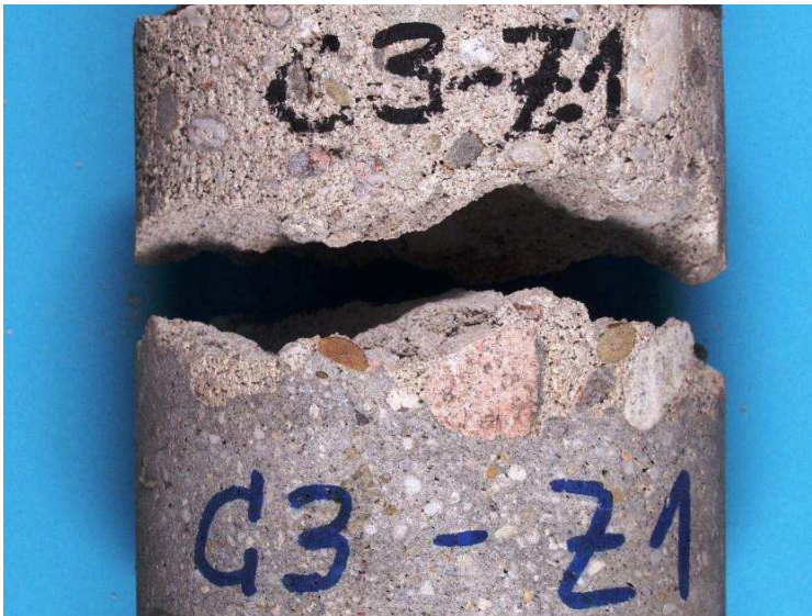
Bild 2: Bruchbild Verbundprobe SPCC 2 nach der Zugprüfung
