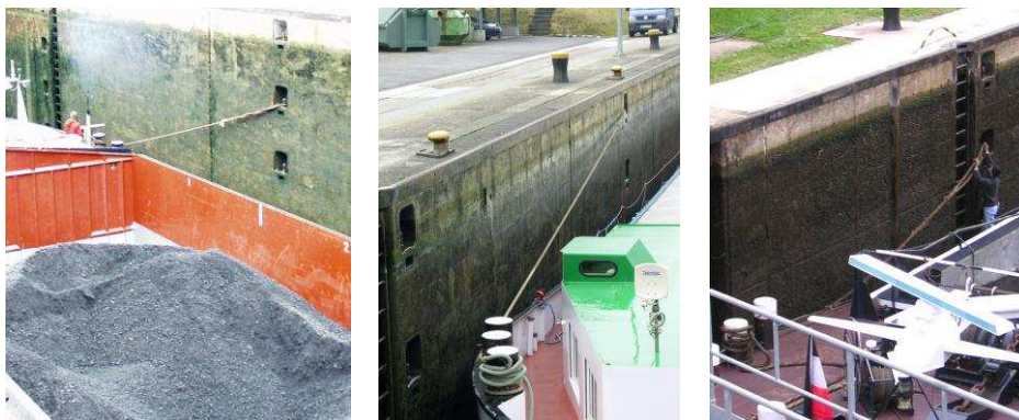
Bild 1a, b und c: Typische Situationen beim Festmachen, Spannen und Lösen der Trossen an Nischenpollern
