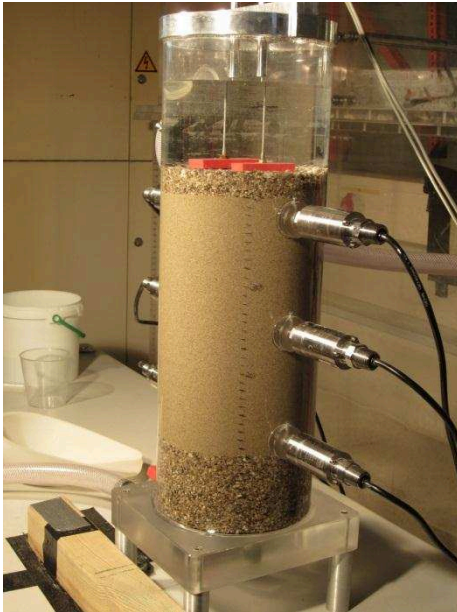
Bild 3: Versuchsaufbau der Zylinderdurchströmungsversuche
