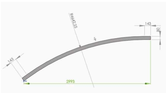
Bild 1: Bauraumgerechte Gestaltung der Torflügelform
