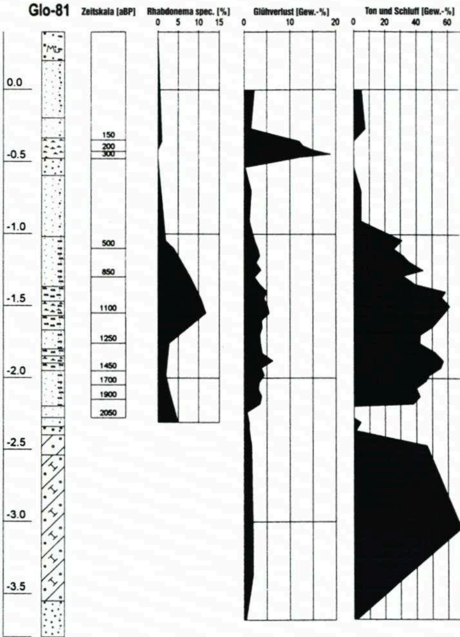
Abb. 10: Bohrprofil Glo-81 mit Zeitskala und Verteilung der Rhabdonema sp. , des Glühverlustes und des Ton-/Schluffgehaltes
