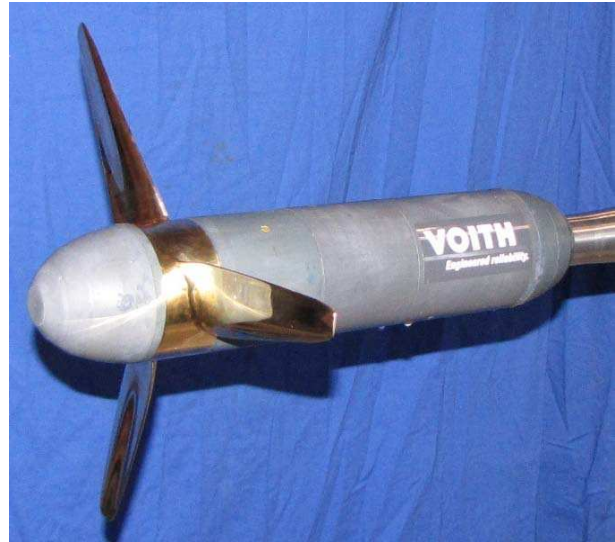
Abb. 11 Voith Hydro Gezeitenströmungsturbinenrotor im Modellmaßstab in Versuchseinrichtung montiert
