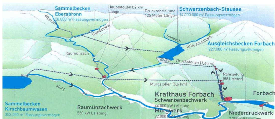
Abbildung 2 Übersichtsschema des Rudolf-Fettweis-Werkes (Quelle EnBW)
