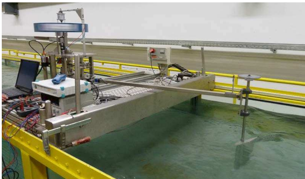
Abbildung 4 Prototyp mit Messaufbau in der Kipprinne
