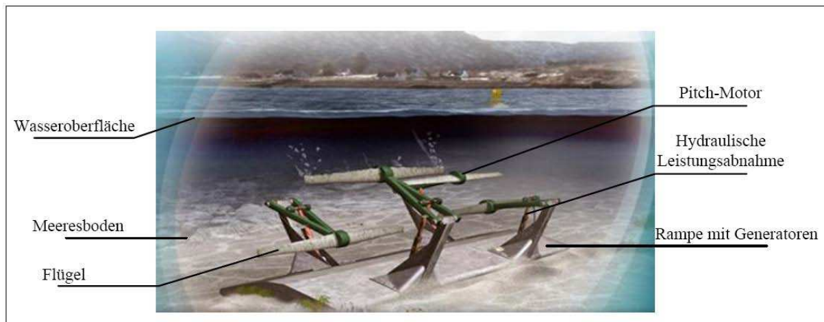
Abbildung 1 Pulse Stream Anlage [2]
