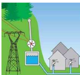
Abb. 5: Prinzip eines Trinkwasserkraftwerks
