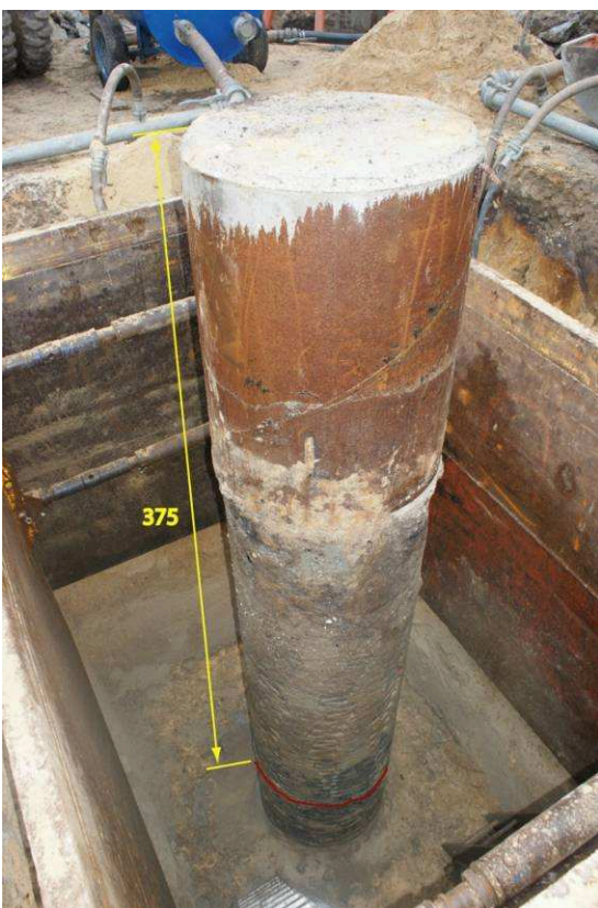
Abbildung 17: Freigelegter Pfahl 7 mit Rissbild
