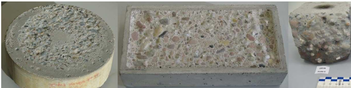
Bild 1: Prüfkörper der Prüfeinrichtung nach [ASTM, (2010)], der Plattenabrasionstrommel und der Verschleißstrommel nach (Bania, 1989) und (Vogel, Müller, 2009)
