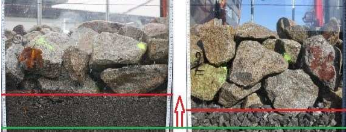
Bild 2: Vergleich Eindringtiefe des Filtermaterials, (li.) Filter 16/32 mm, (re.) Filter 2/16 mm
