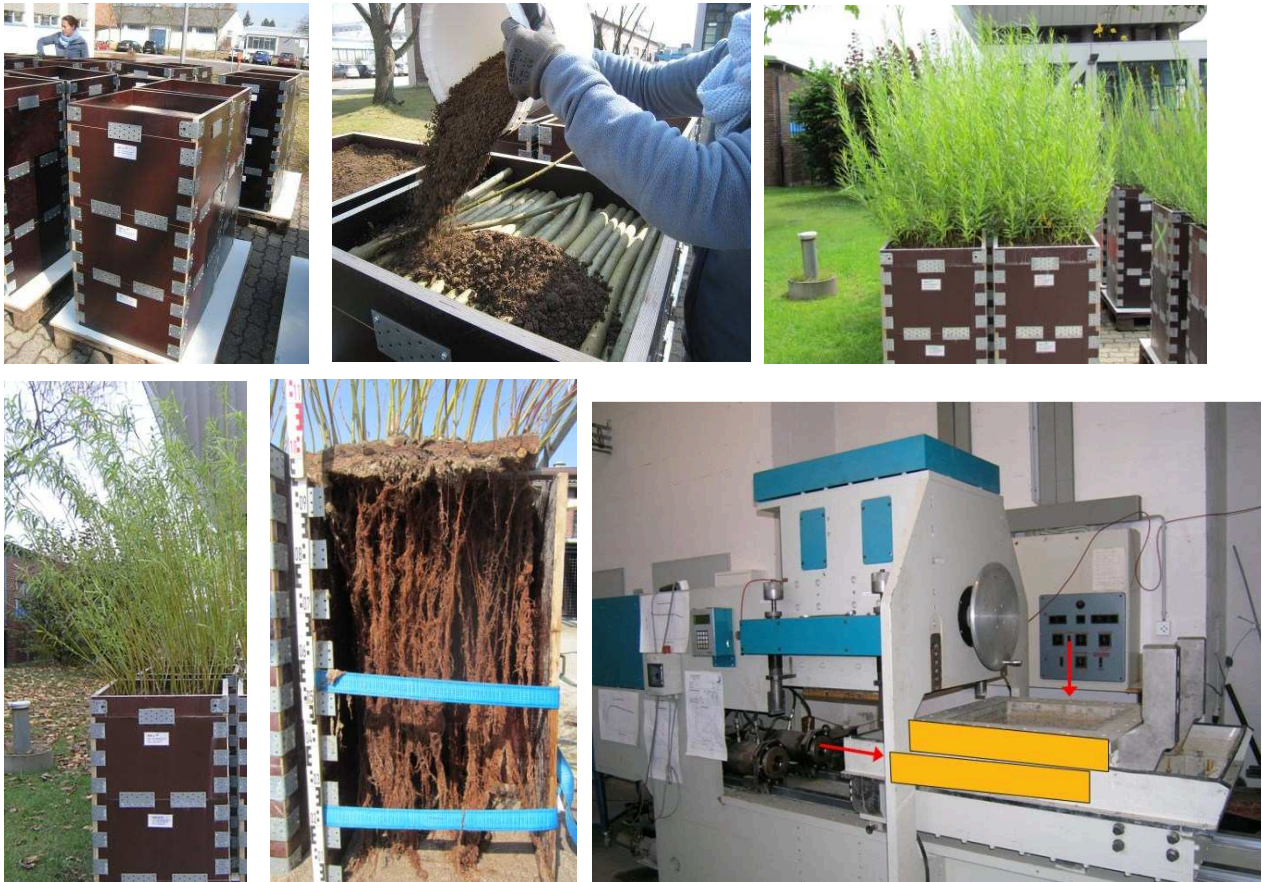
Bild 2: Versuchskästen zur Anzucht von Weidenspreitlagen für Scherversuche und Großschergerät
