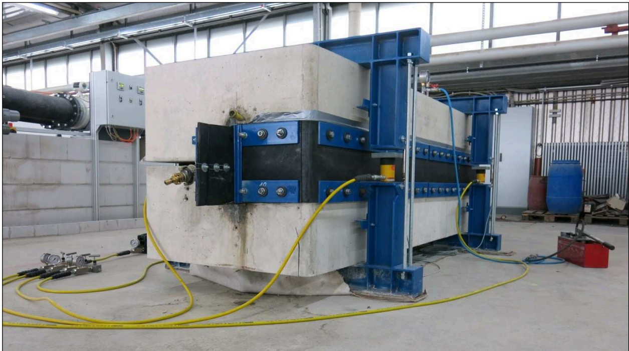
Bild 1: Betonmodell für die Fugensimulation in der BAW
