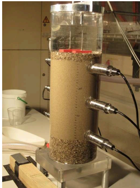
Bild 3: Versuchsaufbau der Zylinderdurchströmungsversuche
