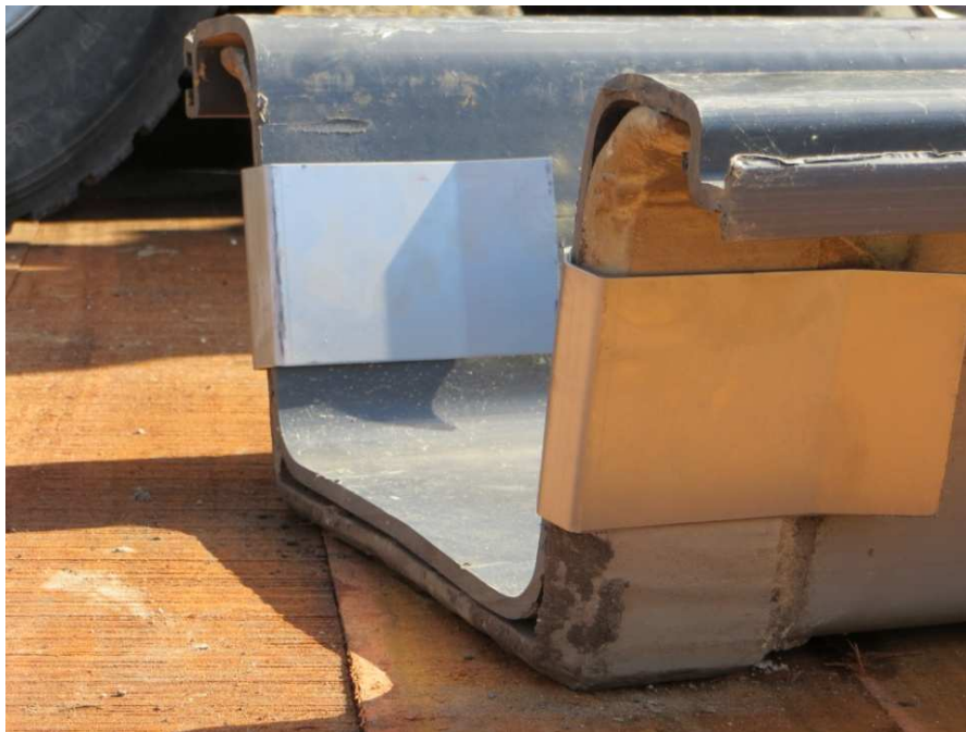
Abbildung 2: Mitlaufende Mutterbohle und Stahlklammern
