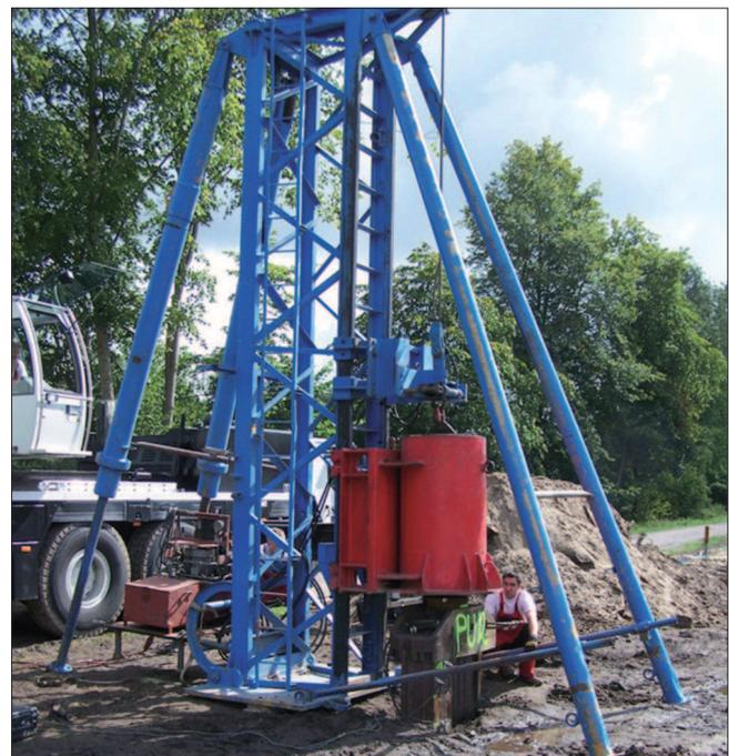
Bild 3: Aufbauten für die statischen Zugversuche (oben) und die dynamischen Probelastungen (unten, Quelle: WNA Datteln)
