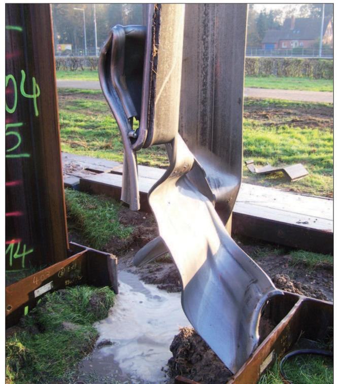
Bild 2: Proberammungen in Venhaus; gezogene Zwischenbohle der kombinierten Spundwand in Gleesen (Quelle: WNA Datteln)
