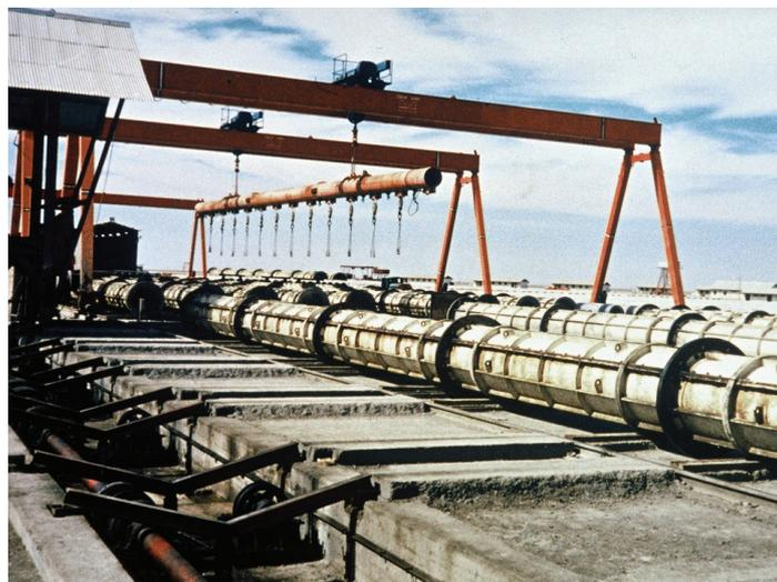
Bild 5: Spannbetonhohlpfahlherstellung
