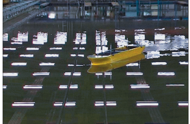
Bild 13: Freifahrten im Schiffswellenbecken zur Erfassung der dreidimensionalen Schiffsdynamik bei Standard-Z-Manövern
