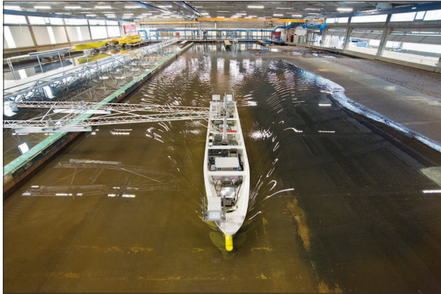
Bild 12: Modellkonfiguration bei der Erfassung von Querkraften und Giermomenten am Schiff u. a. bei der Passage verschiedener Uferformen
