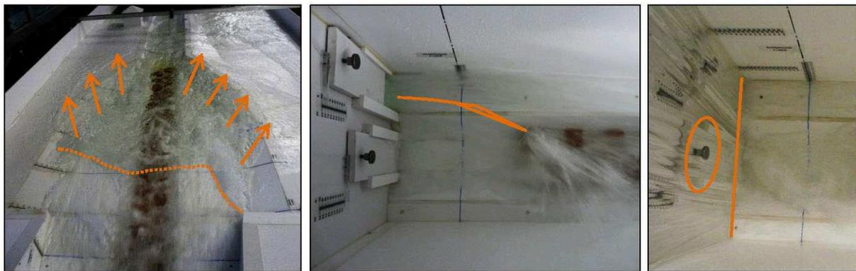
**Abbildung 3:** Ursprünglicher Entwurf: Lage des Wechselsprungs und Wasserübertritt an den Böschungen der Tosmulde,  $BHQ_2$  (links), Strahlaufwurf an den Steinen im Hauptgerinne (mittig), Beeinflussung der Betriebsauslässe (rechts)
