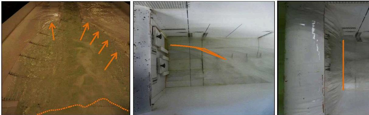
**Abbildung 5:** Modifizierter Entwurf: Lage des Wechselsprungs und Wasserübertritt an den Böschungen der Tosmulde während  $BHQ_2$  (links), reduzierter Strahlaufwurf an den Querriegeln im Hauptgerinne (mittig), Auftrittspunkt des geschlossenen Wurfstrahls während  $BHQ_2$  (rechts)
