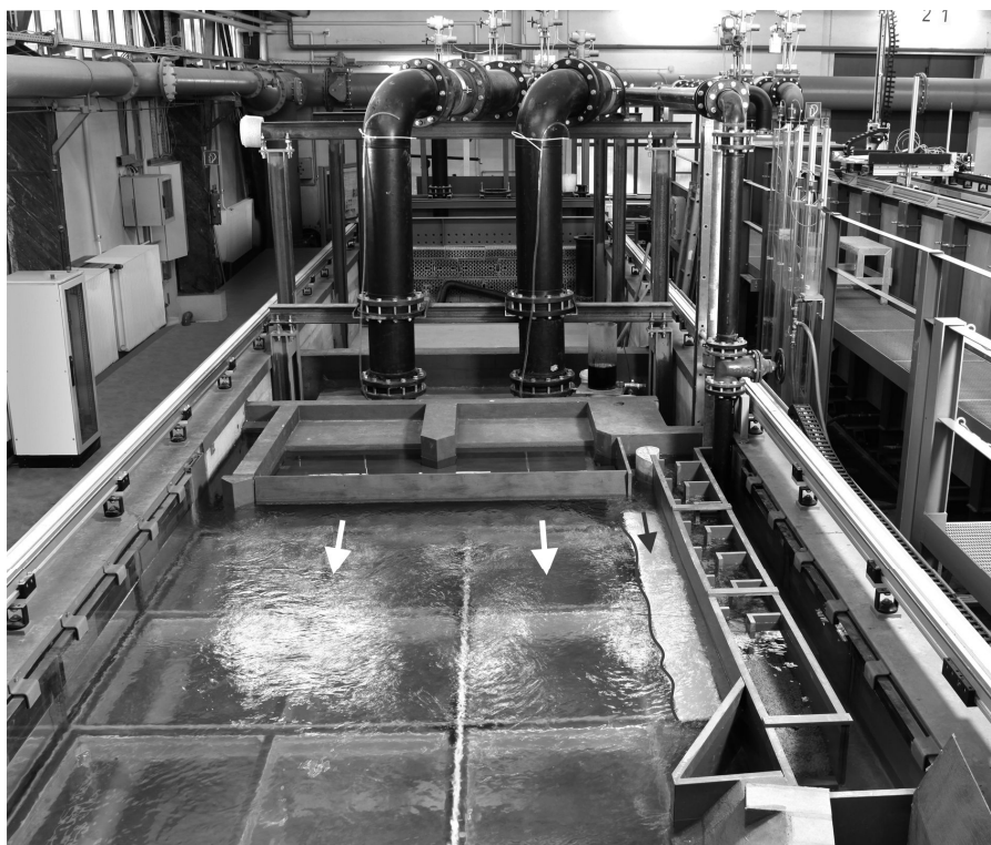
Abbildung 4: Physikalisches Modell des Unterwassers Lauffen: Blick von unterstrom auf den Kraftwerksauslass, rechts der Einstieg in die Fischaufstiegsanlage
