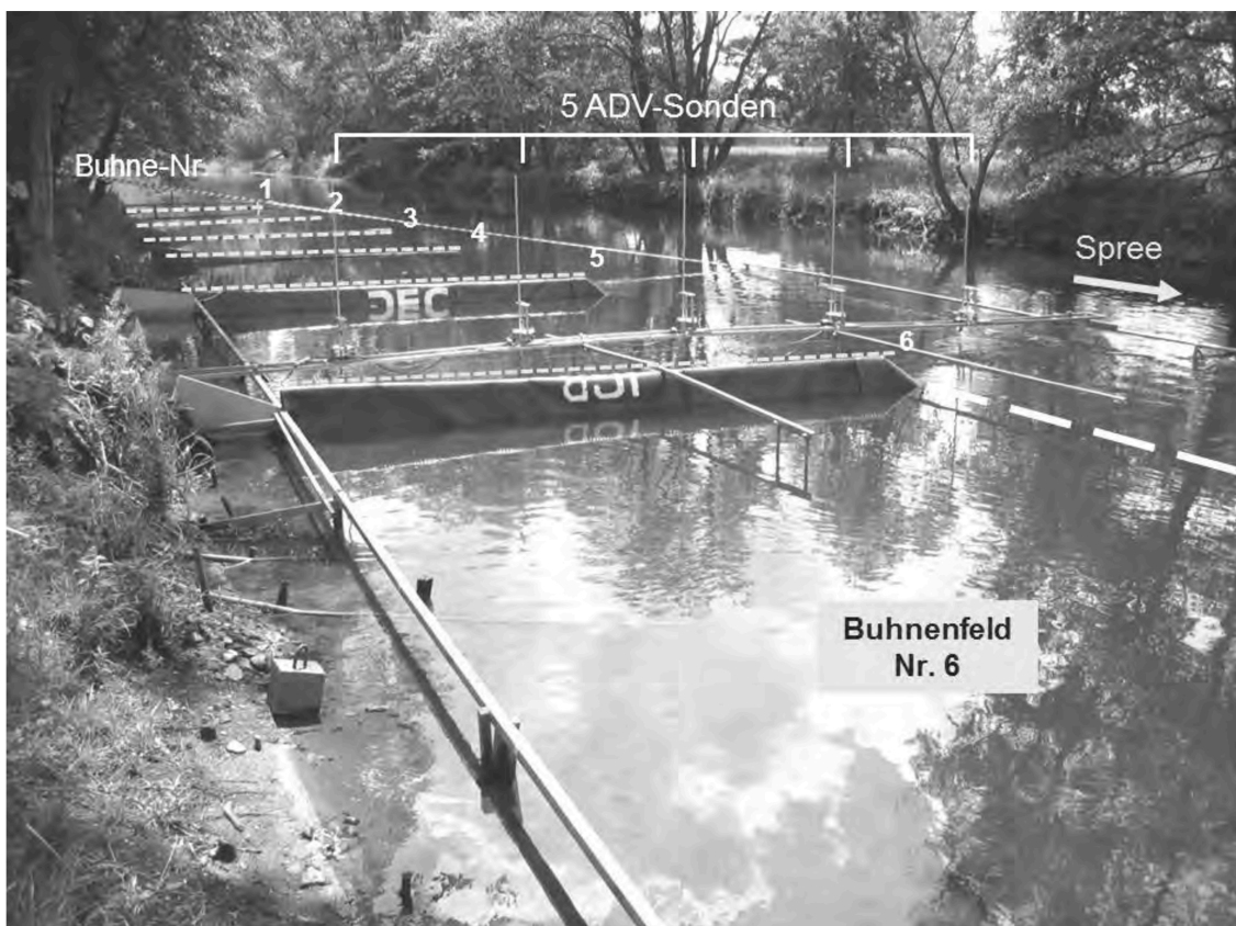
Abbildung 2: Experimentelle Buhnenfelder mit Messrahmen und ADVs (Experiment 2)
