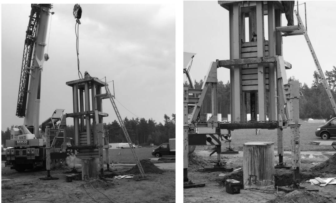
**Abb. 8:** Dynamische Probelastungen
