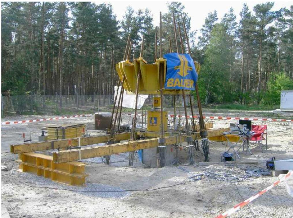
**Abb. 6:** Statische Pfahlprobelastung
