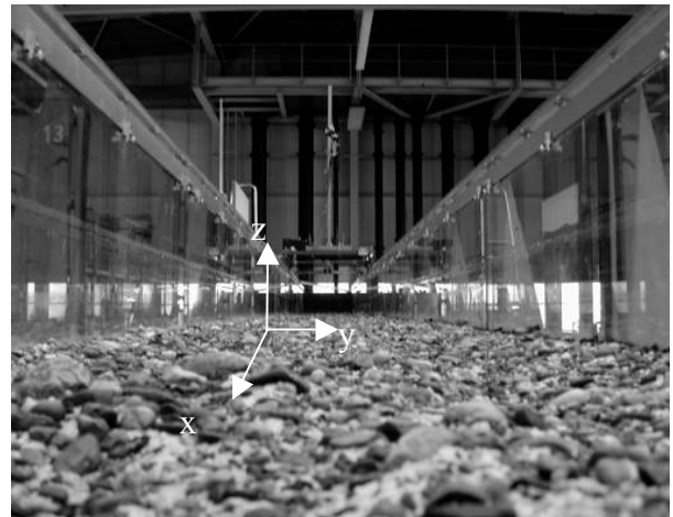
Bild 2.2: Versuchsrinne und Sohlenstruktur nach einer Beaufschlagung mit einem Durchfluss von Q = 180 \text{ l/s}
