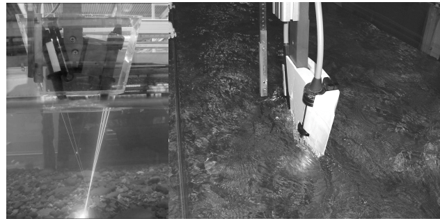
Bild 2.3: LDA-Setup mit Tank für Messungen in geringen Wassertiefen und in Distanzen kleiner 170 mm zu den Sonden (links) und LDA-Setup mit Verkleidung für Messungen im sohlennahen Bereich bei großen Wassertiefen (rechts).
