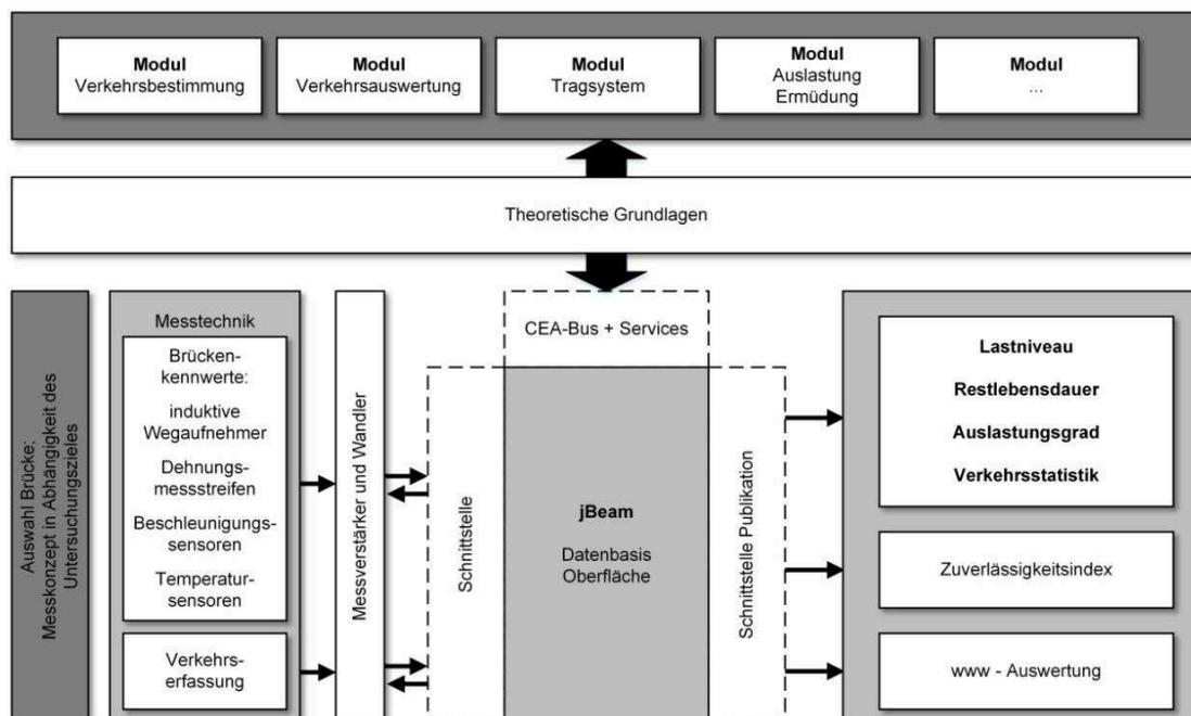
Abbildung 1: Aufbau des Monitoringsystems zur Ermittlung von Verkehrslastmodellen
