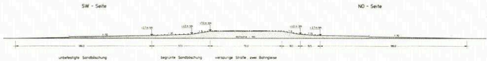
Abb. 2. Querschnitt des Damms mit unbefestigter Böschung und der Neigung natürlicher Strände (GÖHREN, 1973, Abb. 19)
