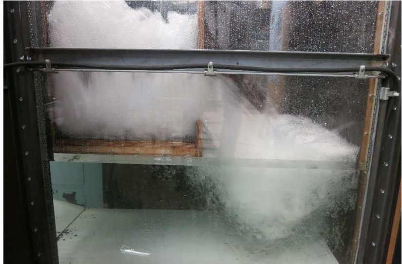
Bild 9: Hydraulische Modellversuche Energieumwandlungsschacht am IWG, KIT Karlsruhe
