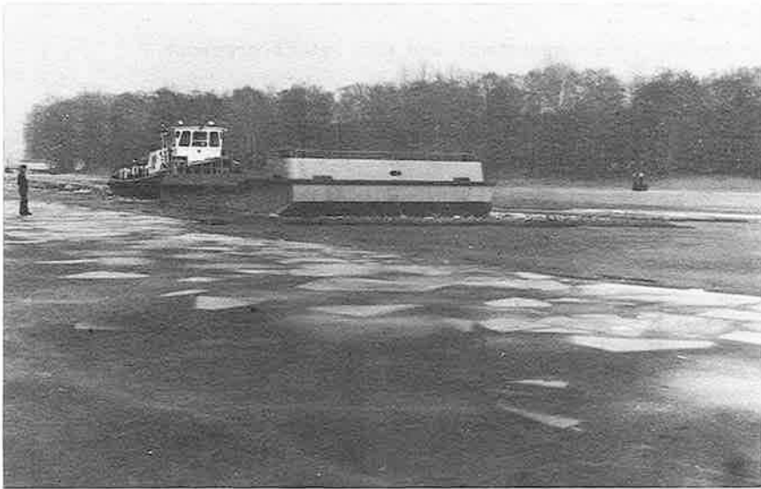
Bild 9 Verband Eisbrecher 220 kW Typ "Havel" und Eisponton
