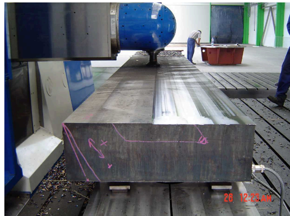
Bild 9: Werksfertigung der Grundschiene
