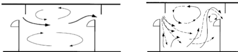
**Abb. 3:** Strömungssignaturen in Schlitzpässen: flow pattern I (links), flow pattern II (rechts)
